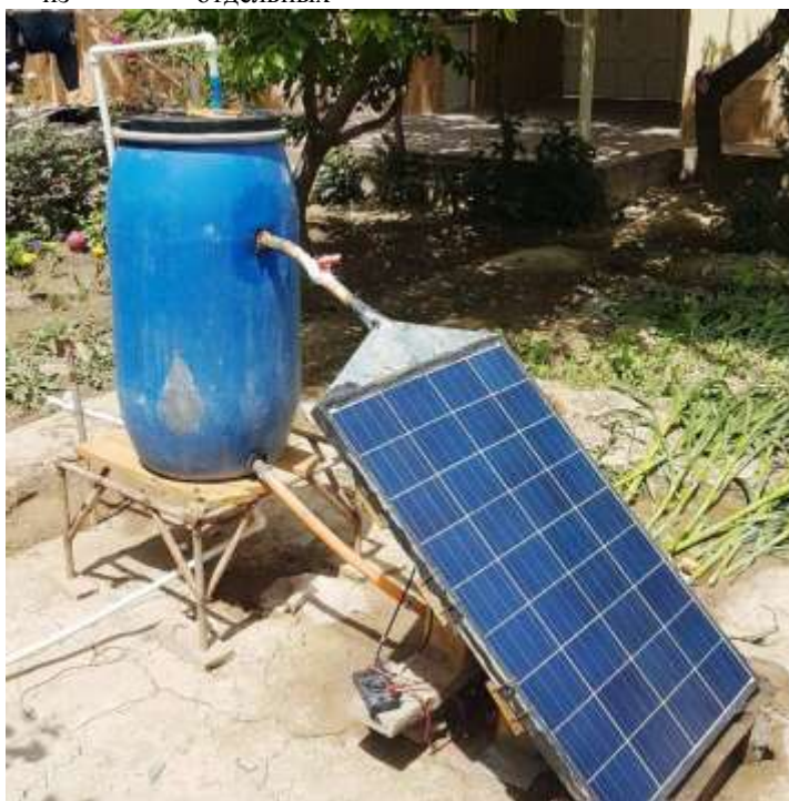
Рис. 1. Термофотоэлектрическая солнечная установка
