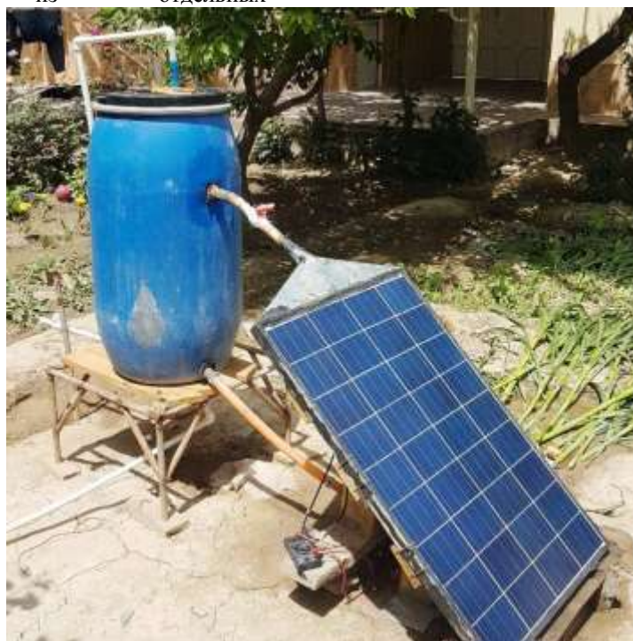
Рис. 1. Термофотоэлектрическая солнечная установка
