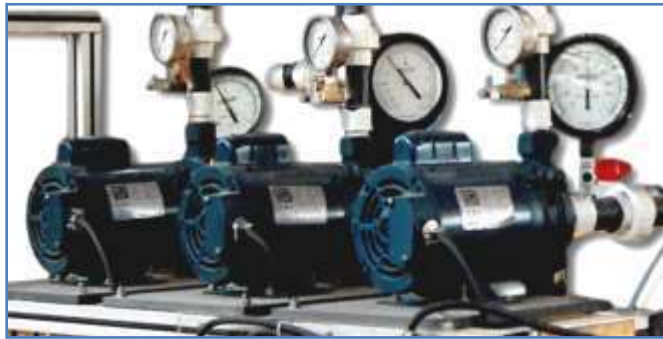
Fig. 5.- \frac{3}{4} , 1, 1.5 Hp pumps.
